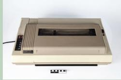
**Impressora matricial**, cujo funcionamento consiste no contato de micro agulhas e uma fita encharcada de tinta. São normalmente utilizadas em empresas que utilizam folhas carbonadas e precisam arquivar 2as vias de documentos fiscais. Caracterizam-se por terem um baixo custo de impressão, porém, dependendo do tipo de impressão podem ser lentas e barulhentas.
