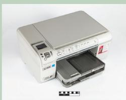
**Impressora multifuncional** agrega características de dispositivos de entrada (*scanner, fax*) e dispositivos de saída (impressora).
