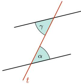
Figura 1.6: Uma reta transversal  $t$  corta duas retas paralelas determinando os ângulos  $\alpha$  e  $\gamma$ . Esses ângulos são *alternos* porque estão em diferentes lados da reta transversal e são *internos* porque estão entre as retas paralelas. Sabe-se que ângulos alternos internos (assim como os alternos externos) são congruente.
