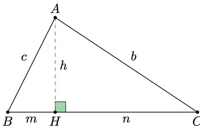
Por simplicidade de notação, sejam  $\overline{BC} = a$ ,  $\overline{AC} = b$ ,  $\overline{AB} = c$ ,  $\overline{AH} = h$ ,  $\overline{BH} = m$  e  $\overline{CH} = n$ . Note que há duas formas de calcularmos a área do  $\triangle ABC$ : a primeira é considerando  $BC$  como base e a segunda é considerando  $AB$  como base. Comparando as fórmulas geradas por essas duas possibilidades, obtemos
