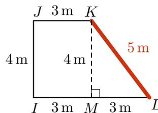
Figura 1.4: cálculo dos comprimentos do lado oblíquo do trapézio retângulo.
