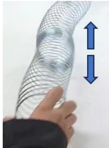
Figura 2: Formação de onda longitudinal em uma mola.
